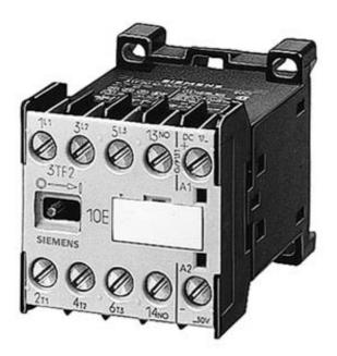
CONTACTOR, SIZE 00, 3-POLE AC-3, 4KW/400V, SCREW TERMINALS AUXILIARY CONTACT 10E (1NO) DC SOLENOID SYSTEM DC 24V
